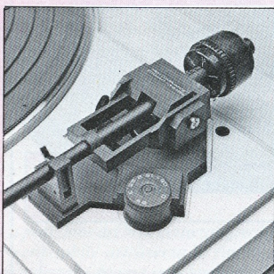
Il braccio del KD-41 R è dritto, bilanciato staticamente ed è correttamente dimensionato, come dimostra il grafico dell'errore radiale.
